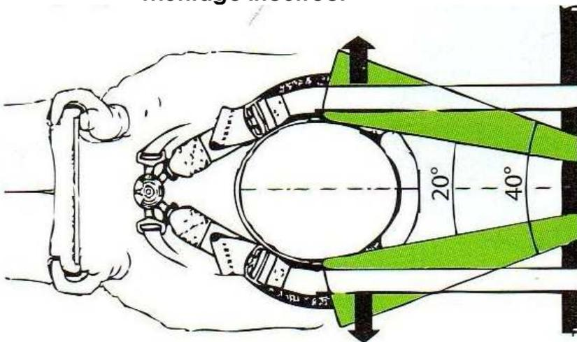
La fixation du harnais sur le tube transversal n'est pas dans la zone verte définie par les angles de 20° et 40°. Le harnais peut glisser du HANS (flèches rouges).
