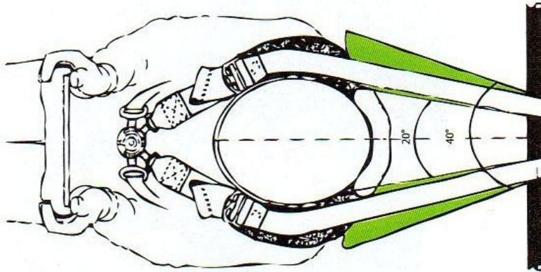
L'angle du harnais doit être situé entre 20° et 40° par rapport à l'axe longitudinal (zone verte).
