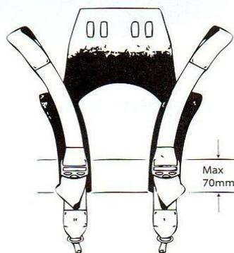
Distance maximum entre l'extrémité supérieure de la boucle de serrage et l'extrémité du HANS est de : 70 mm
